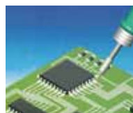
Soldadura de dos ángulos opuestos del componente en el soldador.
