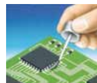
Aplicación del flux sobre los pads y los leads del CI.
