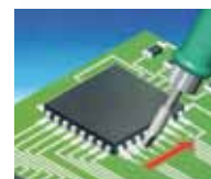
Soldadura de los leads con las puntas especiales para soldar CI SMD de JBC.
