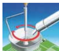
Desoldado del componente por aire caliente.
