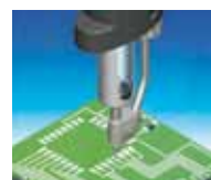
Limpieza de los pads del circuito con el desoldador.
