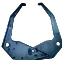
**Calibre para medición de ancho**
