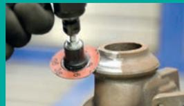
**CONSEJO.** Evite el raspado en contornos utilizando un soporte de menor tamaño que el diámetro de los discos, por ejemplo, un soporte de 38 mm para 50 mm.
