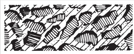
ESTRUCTURA ABIERTA (1/3 MENOS DE GRANO QUE EN LA ESTRUCTURA CERRADA)
