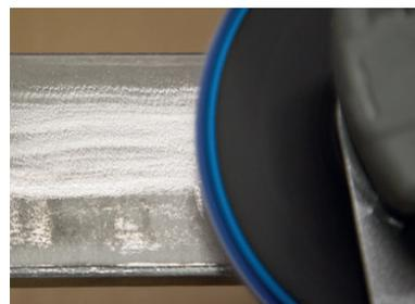
Capa 'supersize' para un corte más frío y menor generación de calor durante su uso, obteniéndose una pieza de mejor calidad y sin marcas de quemadura
