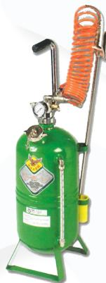
Para pulverización atóxica de líquidos de baja densidad como detergentes, aceites, lubricantes y afines. Eficaces para lavado de vehículos, grafitado, lubricación, distribución aceite para desmontar, etc... Llenado de líquido a 3/4 de su capacidad y presurizados a 6 - 8 bar. Sin necesidad de conexión continuada a la red de aire comprimido
