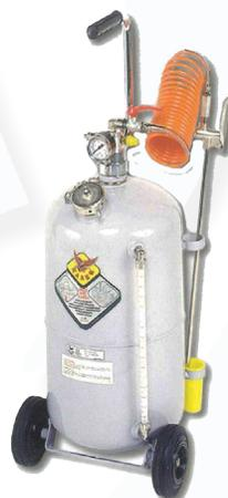
Para pulverización atóxica de líquidos de baja densidad como detergentes, aceites, lubricantes y afines. Llenado de líquido a 3/4 de su capacidad y presurizados a 6 - 8 bar. Sin necesidad de conexión continuada a la red de aire comprimido
