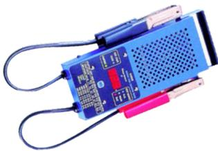
Indicador numérico del estado de la batería y analizador del sistema de carga. Prueba de 200 a 1000 CCA (6-12 V). Prueba del sistema de carga 12 V y del sistema de arranque del motor. Peso 1,2 Kg
