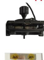
Provisto de medidor electrónico de tensión. Comprobador de fácil manejo. Funciona con una pila de 9V. Detecta la tensión por presión
